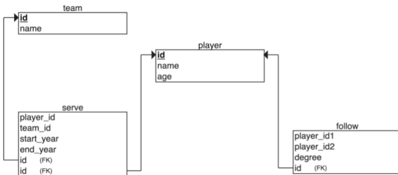
这种存储边的方式在关联小型数据集时问题并不大，但是当关系型数据库中的关系太多时，问题就出现了。事实上，关系型数据库是非常“反关系的”。具体来说，当你只想查询一个球员的队友时，你必须对表中的所有数据进行 join 操作，然后再过滤掉你不需要的所有数据，当你的数据集达到一定规模时，这将给关系型数据库带来巨大压力。如果你想关联多张不同的表，可能在 join 爆炸（join bombs）前系统就已经无法响应了。
