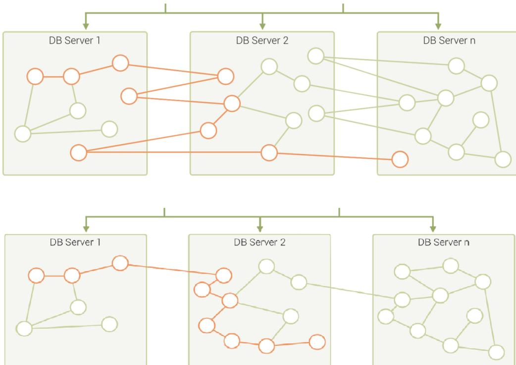
具体工程实践时，也会混合使用上述几种方式。通常，离线的图处理系统会通过一个ETL过程，将图进行一定程度的预处理以提高局部性；而在线图数据库系统通常会选择周期性的数据再平衡过程来提高数据局部性。
