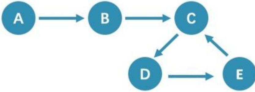
从点 A 开始查询距离 5 跳的点，都会查询到点 C (A->B->C->D->E->C)，查询 6 跳的点时，GO 语句会查询到点 D (A->B->C->D->E->C->D)，因为边 C->D 可以重复查询，而 MATCH 语句查询为空，因为边不可以重复。
