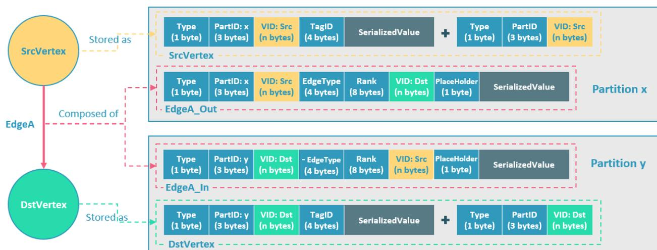
上图以最简单的两个点和一条边为例，起点 SrcVertex 通过边 EdgeA 连接目的点 DstVertex，形成路径 (SrcVertex)-[EdgeA]->(DstVertex)。这两个点和一条边会以 6 个键值对的形式保存在存储层的两个不同分片，即 Partition x 和 Partition y 中，详细说明如下：
