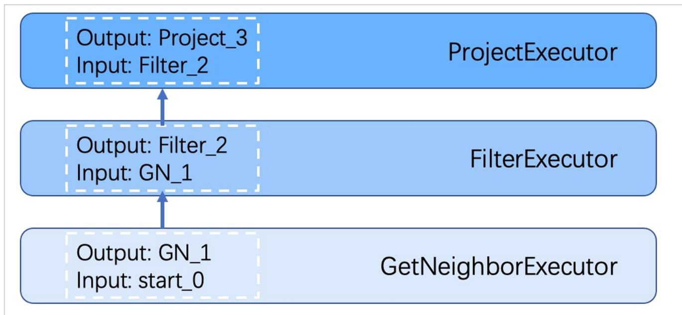
每一个执行计划节点都一一对应一个执行算子，节点的输入输出在优化执行计划时已经确定，每个算子只需要拿到输入变量中的值进行计算，最后将计算结果放入对应的输出变量中即可，所以只需要从节点 `start` 一步步执行，最后一个算子的输出变量会作为最终结果返回给客户端。
