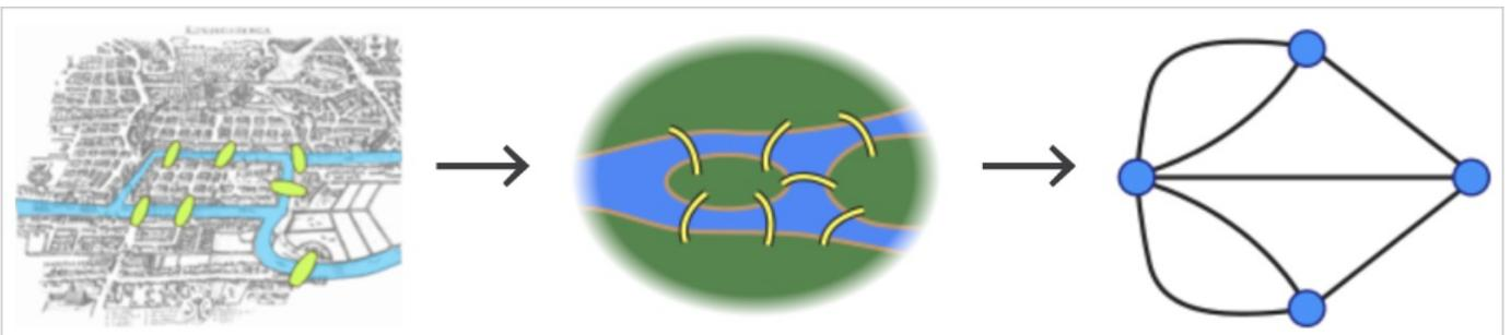
图中四个点代表柯尼斯堡的四个区域，点之间的线代表连接四个区域的七座桥。从图中不难看出，偶数座桥连接的区域可以轻松通过，因为来去可以选择不同的路线。奇数座桥连接的区域只能作为起点或者终点，因为同样的路线只能走一次。和节点相关联的边的条数称为节点度。现在可以证明，只有两个节点有奇数度，另外节点有偶数度时，也即两个区域必须有偶数座桥，剩下的区域有奇数座桥时，柯尼斯堡问题才能解决。欧拉论述了，由于柯尼斯堡七桥问题中所有区域都为奇数度，它无法实现符合题意的遍历。
