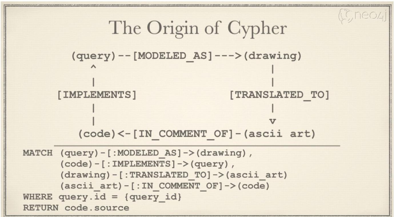
ASCII art 简单说，就是如何用可打印文本来描述点和边。Cypher 文本用 () 表示点，`-[]->` 表示边。`(query)-[modeled as]->(drawing)` 来表示 起点 query， 终点 drawing， 边 modeled as， 这样一个最简单的图关系(也可以称为图模式)。
